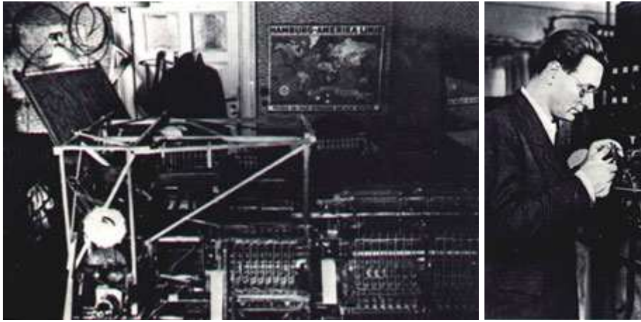
Konrad Zuse: il calcolatore Z1 e zuse che lavora al calcolatore Z4 con nastro perforato ricavato da vecchie pellicole cinematografiche.
