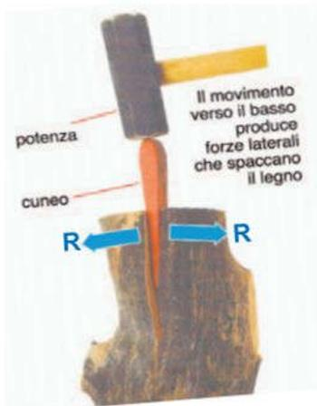
Il cuneo, formato dall'unione di due piani inclinati, scompone la potenza in due direzioni, perpendicolari ai due piani che lo costituiscono; nel materiale in cui è inserito, per esempio un ceppo di legno, vengono quindi applicate due forze divergenti. Il cuneo è una macchina vantaggiosa, perché la potenza è sempre inferiore alla resistenza alla resistenza
